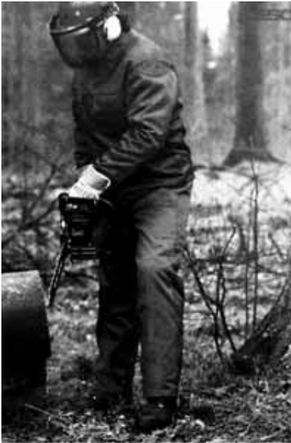
Abb. 15: Beispiel einer Schnitt- schutzhose nach DIN EN 381-5
